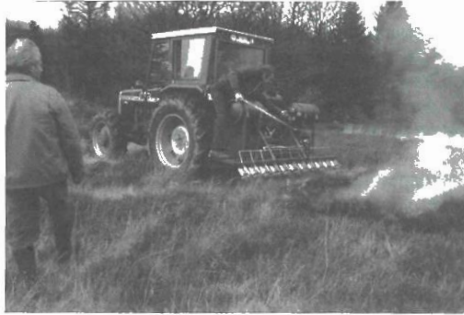
Figure 17 - Brûlage d'un peuplement de myrtilliers. Appareil monté et tracté avec rampe de brûleurs.
