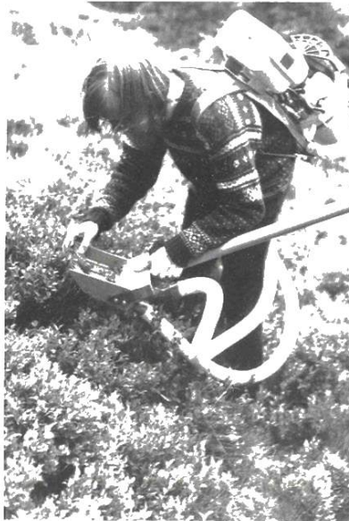
Figure 20 - Prototype d'un appareil de cueillette mécanisée : système à peigne.
