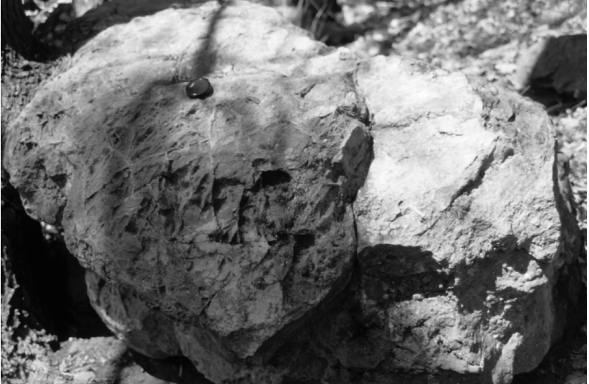
Photo 6 : Bloc de brèche de faille vue sup.- Directions conjuguées d'un réseau de fractures : On observe les directions subperpendiculaires des 2 familles de failles conjuguées, auxquelles se mêlent des fractures secondaires
